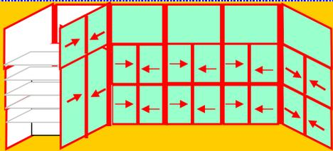
Cerramiento de 7 modulos de 2 y 3 niveles, con hojas correderas y fijos y armario con baldas y escobero.
